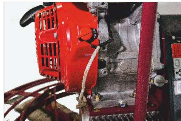
На рисунке показано место крепления провода электропитания на корпусе затирочной машины. Провод электропитания находится внутри ручки управления и должен быть закреплен на корпусе затирочной машины в указанном месте. Данный провод отвечает за экстренную остановку двигателя и связан с защитным предохранительным выключателем на ручке управления затирочной машины.
