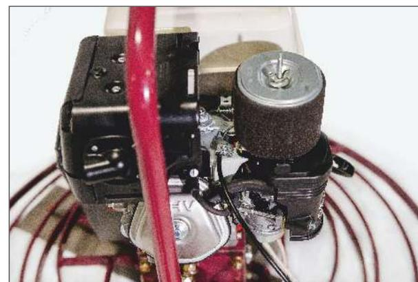
На рисунке показано место крепления троса регулировки дроссельной заслонки (скорость оборотов двигателя). Трос расположен внутри ручки управления и должен быть закреплен на корпусе затирочной машины в указанном месте. Данный трос отвечает за регулировку оборотов двигателя.
