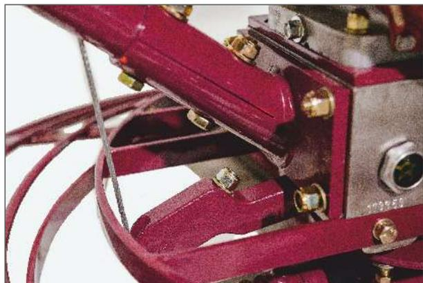
На рисунке показано место крепления троса управления углом наклона лопастей. Трос управления находится внутри ручки управления и его необходимо закрепить на корпусе затирочной машины в указанном месте, с использованием болтового соединения.
